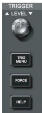
Рисунок 1-11 Зона управления запуском на передней панели
