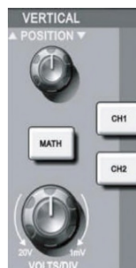
Рисунок 1-9 Зона управления вертикальной разверткой на передней панели
