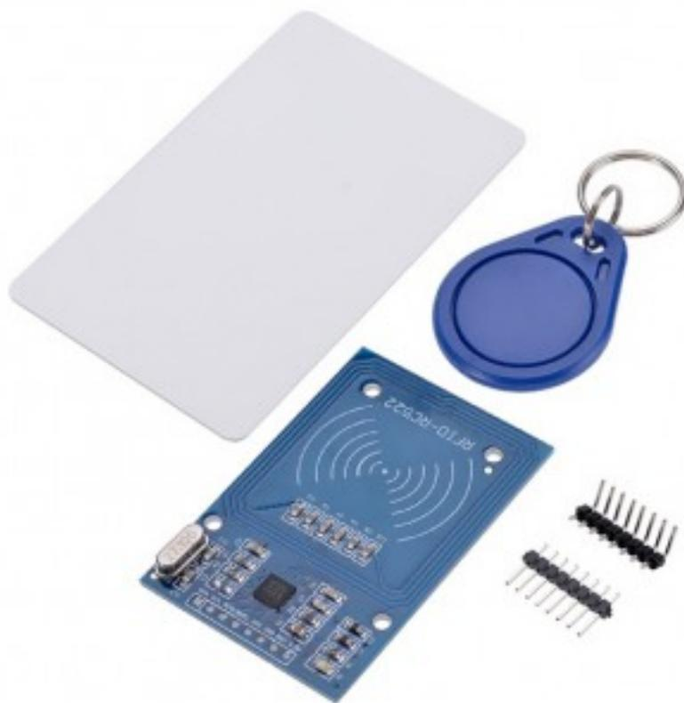
Подключим к плате Arduino модуль RC522 и будем выводить в последовательный порт и на дисплей WH1602 уникальный идентификационный номер (UID) RFID-метки.
