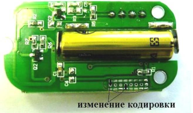
Рис.2 Изменение кодировки брелка
