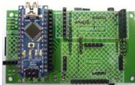
Рис. 4 Установка модуля микроконтроллерного
