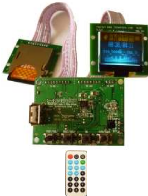
Рис.1. Общий вид плеера в сборе (SD-карта в комплект не входит)
