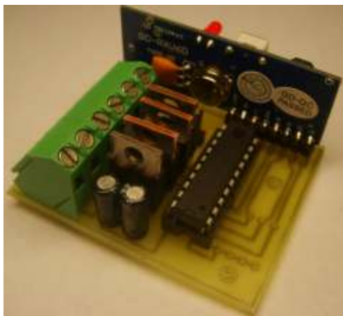
Рис.1 Общий вид собранного изделия (плата приёмника в комплект не входит, на фото показана для наглядности)
