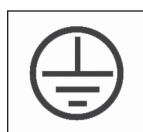
Вывод защитного заземления
