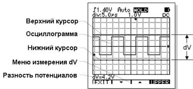
Функция курсорных измерений позволяет измерить разность потенциалов (ΔV) или промежуток времени (Δt) между двумя курсорами на дисплее. При выборе ΔV на дисплее появляются два горизонтальных курсора, а при выборе Δt – два вертикальных
