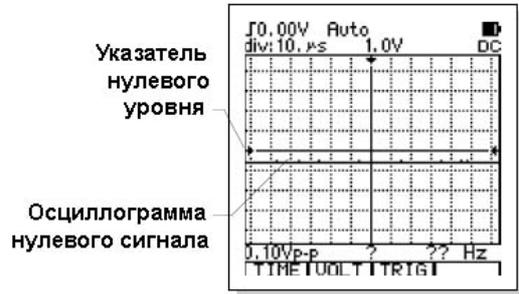
Осциллограмма нулевого сигнала на 6 пунктов ниже указателя нулевого уровня
