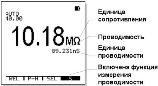
Меню функции измерения сопротивления имеет следующий вид:
