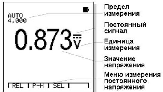
Меню функции измерения напряжения имеет следующий вид:
