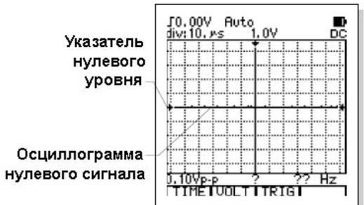
Осциллограмма нулевого сигнала совпадает с нулевым уровнем
