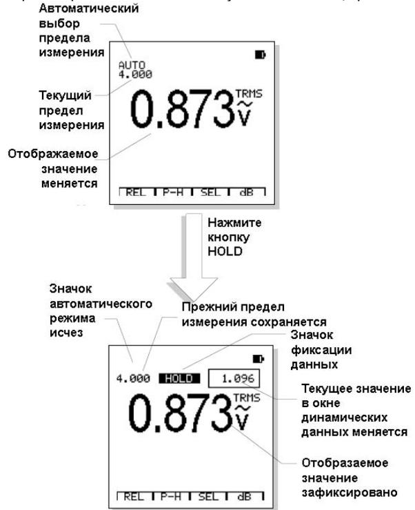
1. Если функция **HOLD** активна, нажмите кнопку **HOLD/MEM** и удерживайте ее 2 секунды для входа в функцию работы с памятью мультиметра, после чего вы можете сохранить зафиксированное значение.
