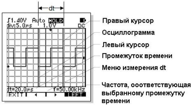
Функция курсорных измерений работает, только когда осциллограмма зафиксирована на дисплее (с помощью кнопки **HOLD** или одиночного режима). После того, как осциллограмма зафиксирована, нажмите кнопку **F4** для входа в подменю курсорных измерений:
