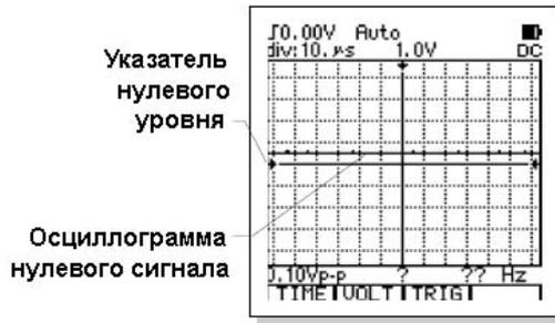
Осциллограмма нулевого сигнала на 5 пунктов выше указателя нулевого уровня
