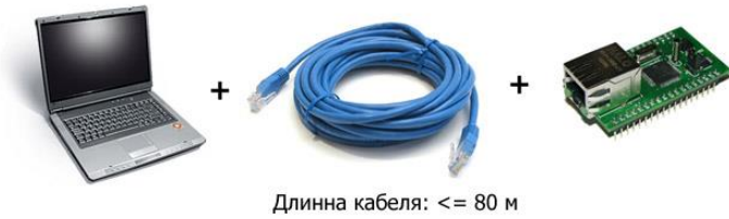
Рис. Схема прямого сетевого подключения компьютер - модуль
