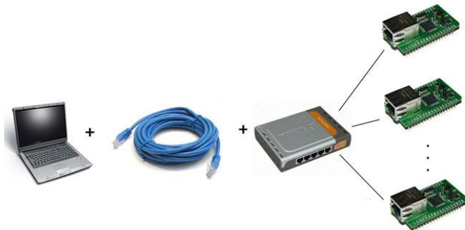
Рис. Схема подключения нескольких модулей к одной сети с использованием роутера
