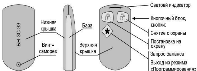
Рис.3 Конструкция брелока. Общий вид
