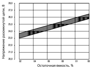
Рис. 2 Напряжение разомкнутой цепи изделия в зависимости от остаточной емкости
