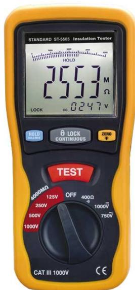
DT-5505 проводит испытание изоляции до 4000 МОм с разрешением 1 кОм напряжением 125В, 250В, 500В и 1000В током 1мА.
