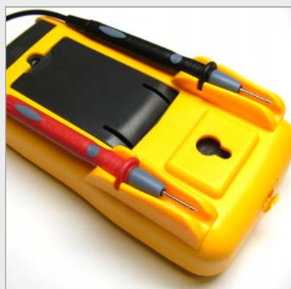
Крепление щупов на корпусе прибора
