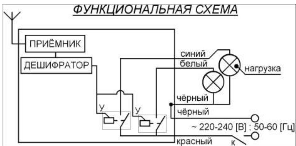
Семейство дистанционных выключателей BEAMISH предназначено для коммутации тока переменного напряжения до 240 [В] (Вольт) с силой тока до 10 [А] (Ампер).
