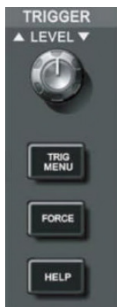
Рисунок 1-11 Зона управления запуском на передней панели
