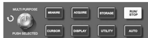
Рисунок 2-21 Функциональная кнопка системы регистрации (STORAGE – запоминание)
