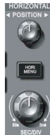
Рисунок 1-10 Зона управления горизонтальной разверткой на передней панели
