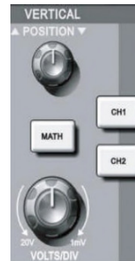
Рисунок 1-9 Зона управления вертикальной разверткой на передней панели
