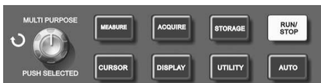
Рисунок 2-28 Функциональная кнопка системы регистрации (cursor – курсор)
