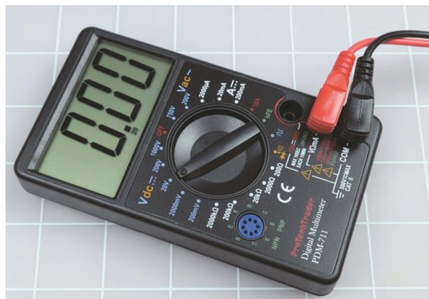
Рис. 1.1. Обычный цифровой мультиметр (шаг фоновой сетки равен 25 мм)
