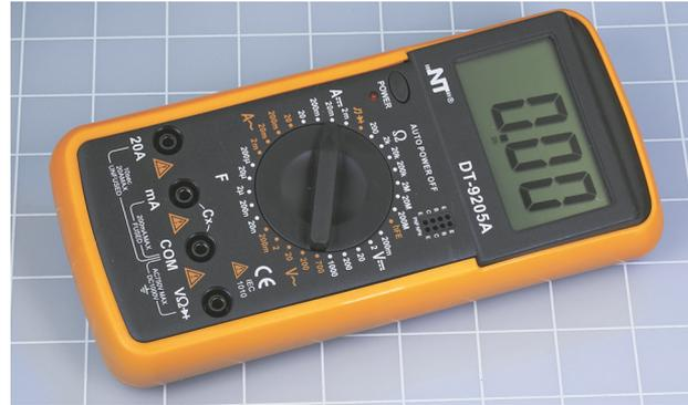
Рис. 1.3. Тестер с ручной установкой диапазона измерений
