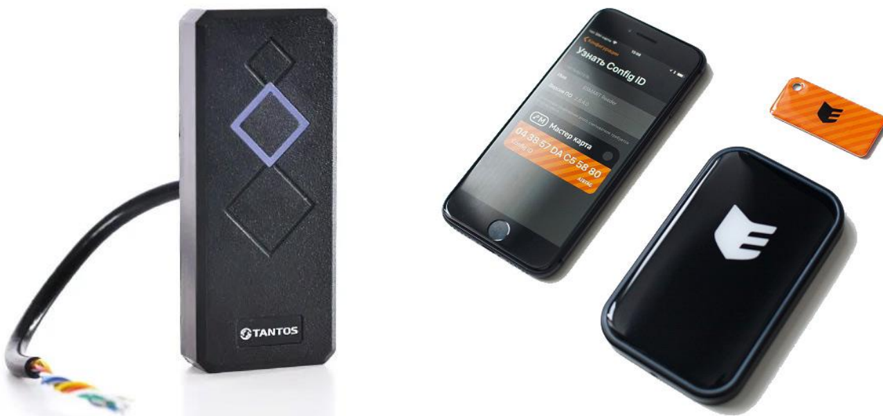
Рис. RFID считыватель TANTOS TS-RDR-E (слева) карт / меток формата EM-MARINE и ESMART Reader с поддержкой как NFC меток так и идентификации по BLE (BlueTooth Low Energy) интерфейсу в связке с мобильным телефоном (с права).
