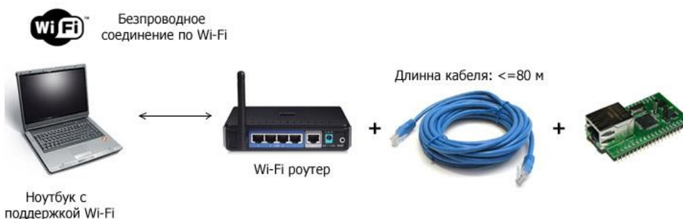
Рис. Схема беспроводного подключения компьютер – модуль с использованием WiFi роутера
