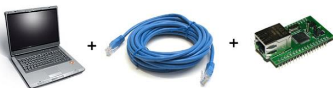
Рис. Схема прямого сетевого подключения компьютер - модуль
